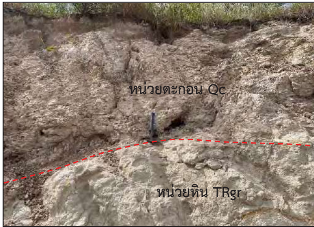
รูปที่ 3-9 แสดงรอยต่อ (Contact) ระหว่างหน่วยตะกอน Qc และเนื้อหินแกรนิต TRgr บริเวณผนังบ่อตอนกลางของพื้นที่คำขอประทานบัตร และลักษณะเนื้อหินที่นำไปใช้สำหรับหินแกรนิตเพื่ออุตสาหกรรมเซรามิก ภาพถ่ายตำแหน่งพิกัด 629622E 1690090N มองไปทางทิศตะวันตก
