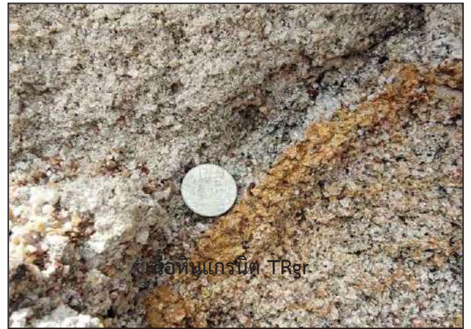
รูปที่ 3-9 แสดงรอยต่อ (Contact) ระหว่างหน่วยตะกอน Qc และเนื้อหินแกรนิต TRgr บริเวณผนังบ่อตอนกลางของพื้นที่คำขอประทานบัตร และลักษณะเนื้อหินที่นำไปใช้สำหรับหินแกรนิตเพื่ออุตสาหกรรมเซรามิก ภาพถ่ายตำแหน่งพิกัด 629622E 1690090N มองไปทางทิศตะวันตก
