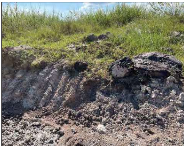
รูปที่ 3-7 ลักษณะหน่วยตะกอน Qc เป็นชั้นตะกอนทรายปนกรวดมนที่มีการเชื่อมประสานกันแน่น พบเม็ดกรวด สีน้ำตาลแกมสีดำของศิลาแลงอยู่ในชั้นตะกอนทราย บริเวณทางทิศตะวันออกเฉียงเหนือของพื้นที่คำขอ ประทานบัตร ภาพถ่ายตำแหน่งพิกัด 629743E 1690130N มองไปทางทิศตะวันตก
