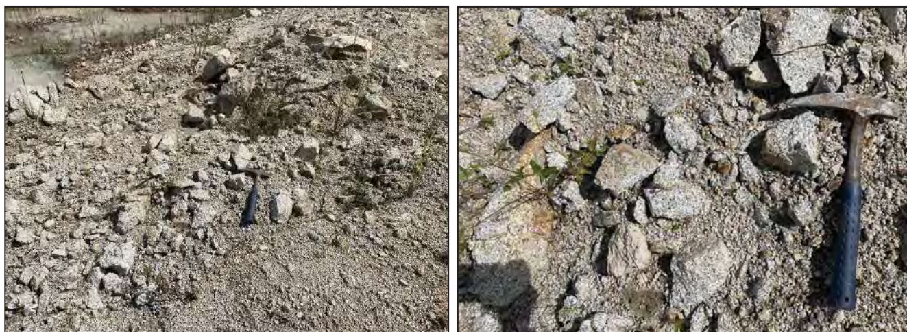
รูปที่ 3-8 หินแกรนิต โดยส่วนใหญ่พบลักษณะเป็นหินแกรนิตผุ พบบริเวณตอนกลางทางตอนเหนือพื้นที่คำขอประทานบัตร ภาพถ่ายตำแหน่งพิกัด 629688 E 1690087 N มองไปทางทิศใต้
