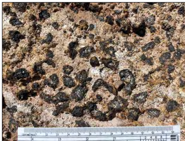
รูปที่ 3-3 ชั้นตะกอน Qc ลักษณะเป็นตะกอนกรวดปนทรายและคิลาแลง (laterite) ที่มีสารเชื่อมประสานเป็นซิลิกา พบทางทิศตะวันออกเฉียงใต้ของพื้นที่คำขอประทานบัตร
