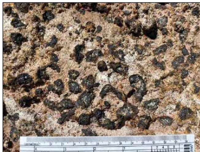
รูปที่ 3-5 ชั้นตะกอน Qc ลักษณะเป็นตะกอนกรวดปนทรายและคิลาแลง (laterite) ที่มีสารเชื่อมประสานเป็นซิลิกา พบทางทิศตะวันออกเฉียงใต้ของพื้นที่คำขอประทานบัตร ภาพถ่ายตำแหน่งพิกัด 629656E 1689907N มองไปทางทิศตะวันตก (ไม้บรรทัดยาว 15 เซนติเมตร)
