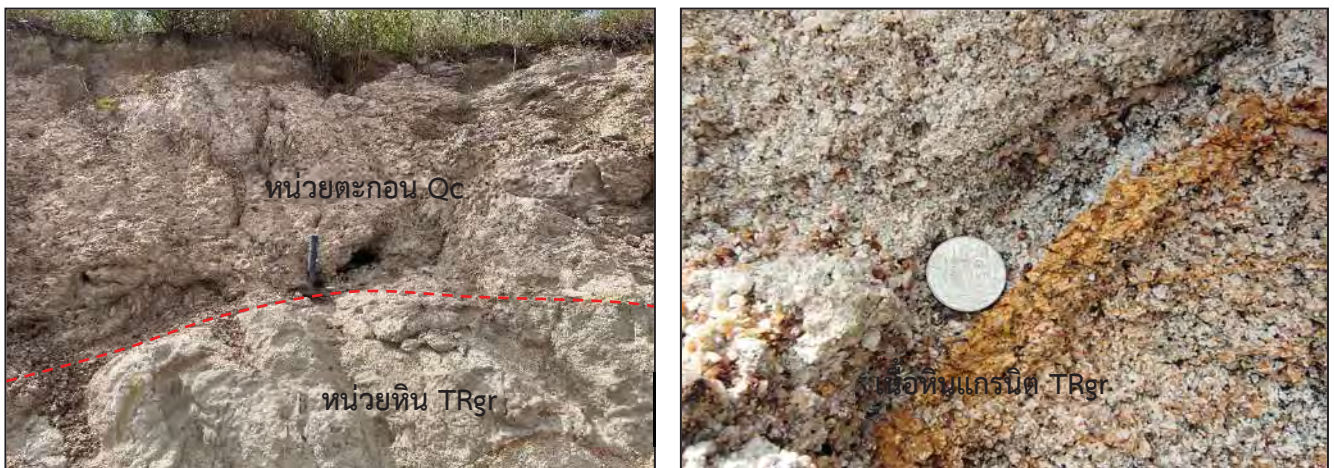
รูปที่ 3-6 แสดงรอยต่อ (Contact) ระหว่างหน่วยตะกอน Qc และเนื้อหินแกรนิต TRgr บริเวณผนังปอดตอนกลางของพื้นที่คำขอประทานบัตร และลักษณะเนื้อหินที่นำไปใช้สำหรับหินแกรนิตเพื่ออุตสาหกรรมเซรามิก ภาพถ่ายตำแหน่งพิกัด 629622E 1690090N มองไปทางทิศตะวันตก
