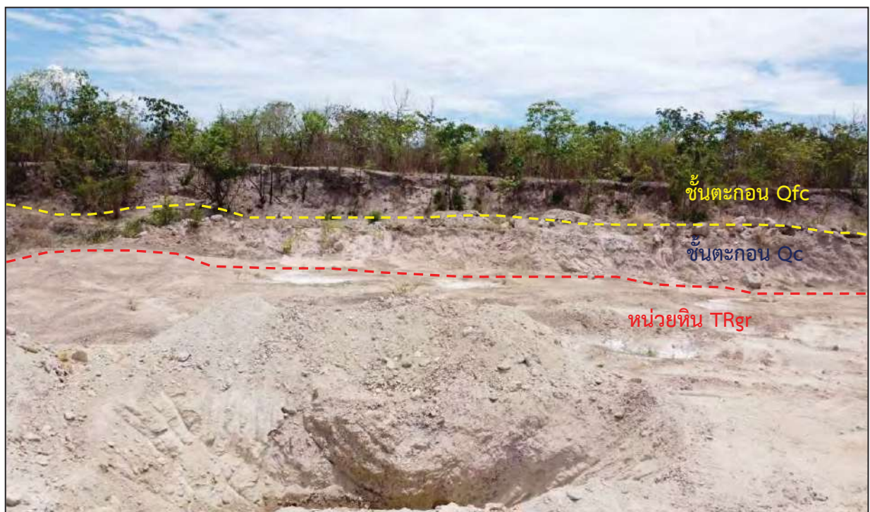
รูปที่ 3-4 แสดงชั้นตะกอน Qfc และ Qc และหน่วยหิน TRgr บริเวณทางตอนกลางของพื้นที่คำขอ ประทานบัตร ภาพถ่ายตำแหน่งพิกัด 629610E 1690085N มองไปทางทิศตะวันตกเฉียงเหนือ
