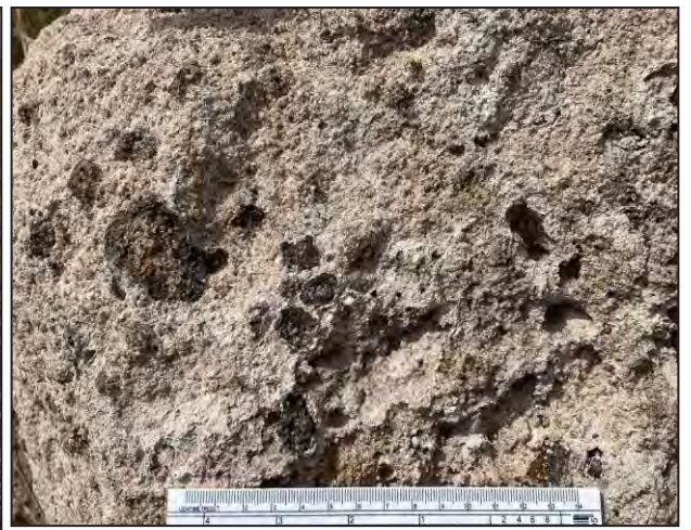
รูปที่ 3-7 ลักษณะหน่วยตะกอน Qc เป็นชั้นตะกอนทรายปนกรวดมนที่มีการเชื่อมประสานกันแน่น พบเม็ดกรวด สีน้ำตาลแกมสีดำของศิลาแลงอยู่ในชั้นตะกอนทราย บริเวณทางทิศตะวันออกเฉียงเหนือของพื้นที่คำขอ ประทานบัตร ภาพถ่ายตำแหน่งพิกัด 629743E 1690130N มองไปทางทิศตะวันตก
