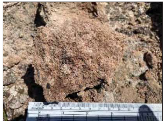
รูปที่ 3-6 หน่วยตะกอน Qc เป็นตะกอนหินกรวดมน สีผิวฝุ่นน้ำตาลดำ ลักษณะผุดลายหินศิลาแลง (laterite) สีผิวสด สีน้ำตาลแดง เนื้อหินลักษณะเป็นเนื้อเม็ด มีเม็ดตะกอนขนาด granule ถึง pebble บริเวณขอบพื้นที่คำขอ ประทานบัตรทางทิศตะวันออกเฉียงใต้ ภาพถ่ายตำแหน่งพิกัด 629683E 1689833N มองไปทางทิศ ตะวันออกเฉียงเหนือ
